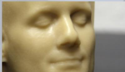
Frästeil direkt aus der Maschine
